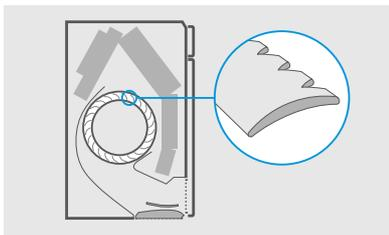
Het nieuwe ontwerp van de ventilator zorgt voor geluidsverspreiding en ruisonderdrukking.
