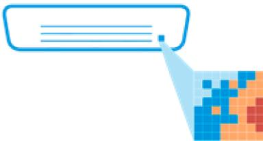
De grid eye sensor meet de oppervlakte-temperatuur van een kamer door deze te verdelen in een rooster met 64 verschillende vierkanten.
